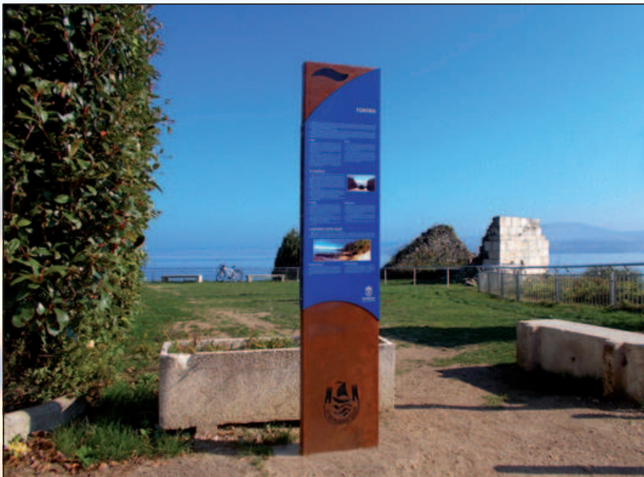
Ayuntamiento de Sada Gama Tótems Específicos 400 x 2000 mm Reflectante RA1 (impresión de vinilo) Mobiliario en Acero Corten
